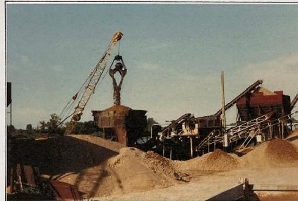
Transport des matériaux dans une trémie vers une station de criblage
