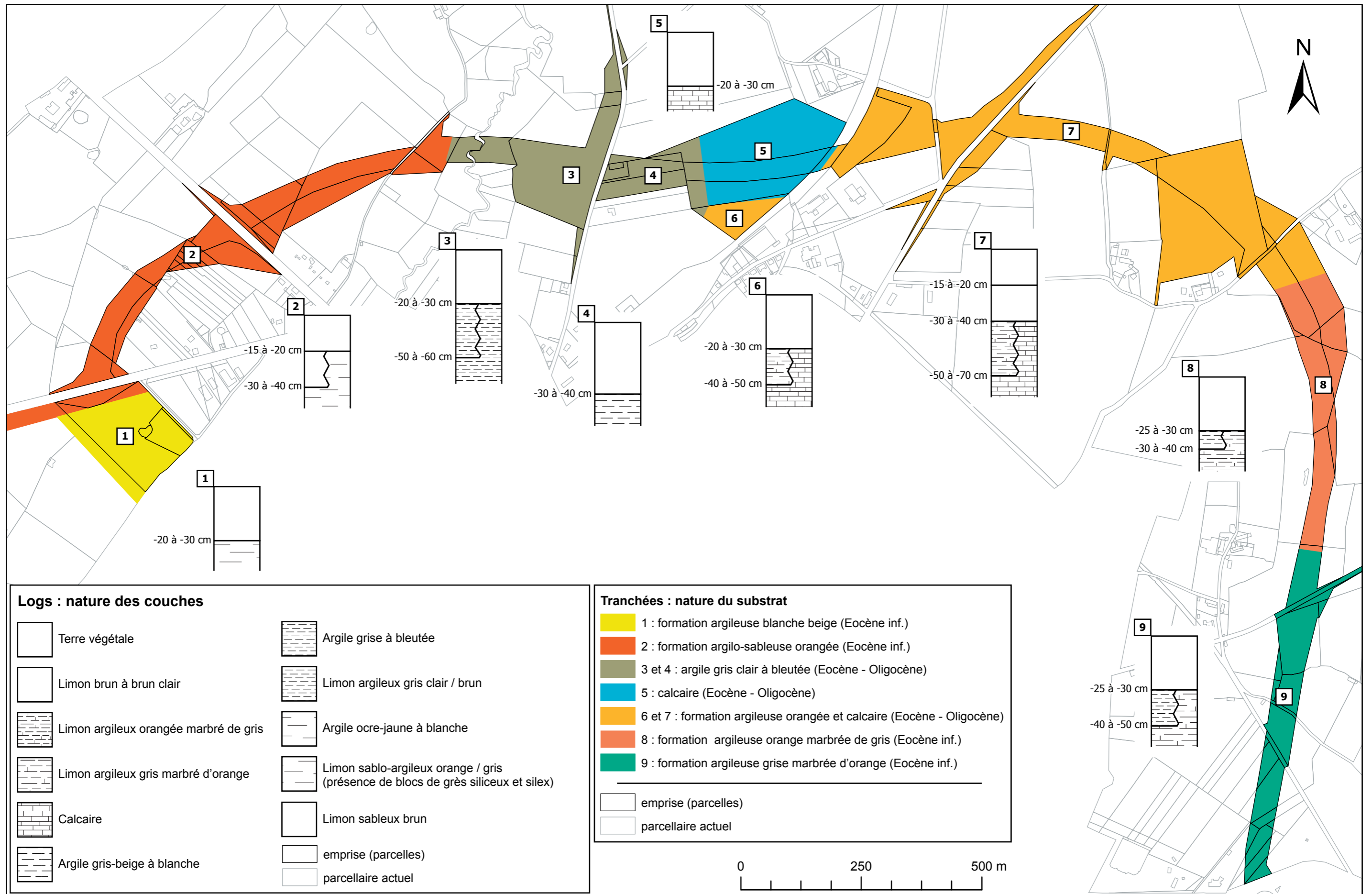
Figure 11 : formations sédimentaires rencontrées le long du tracé – synthèse des logs stratigraphiques des tranchées (M. Gaultier - SADIL)
