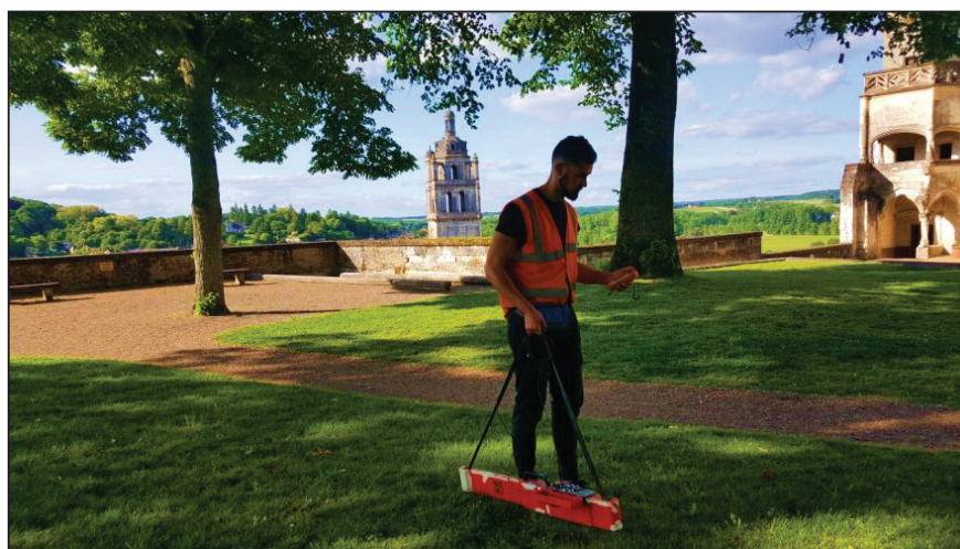
Figure 10 : Acquisition au résistivimètre à induction
