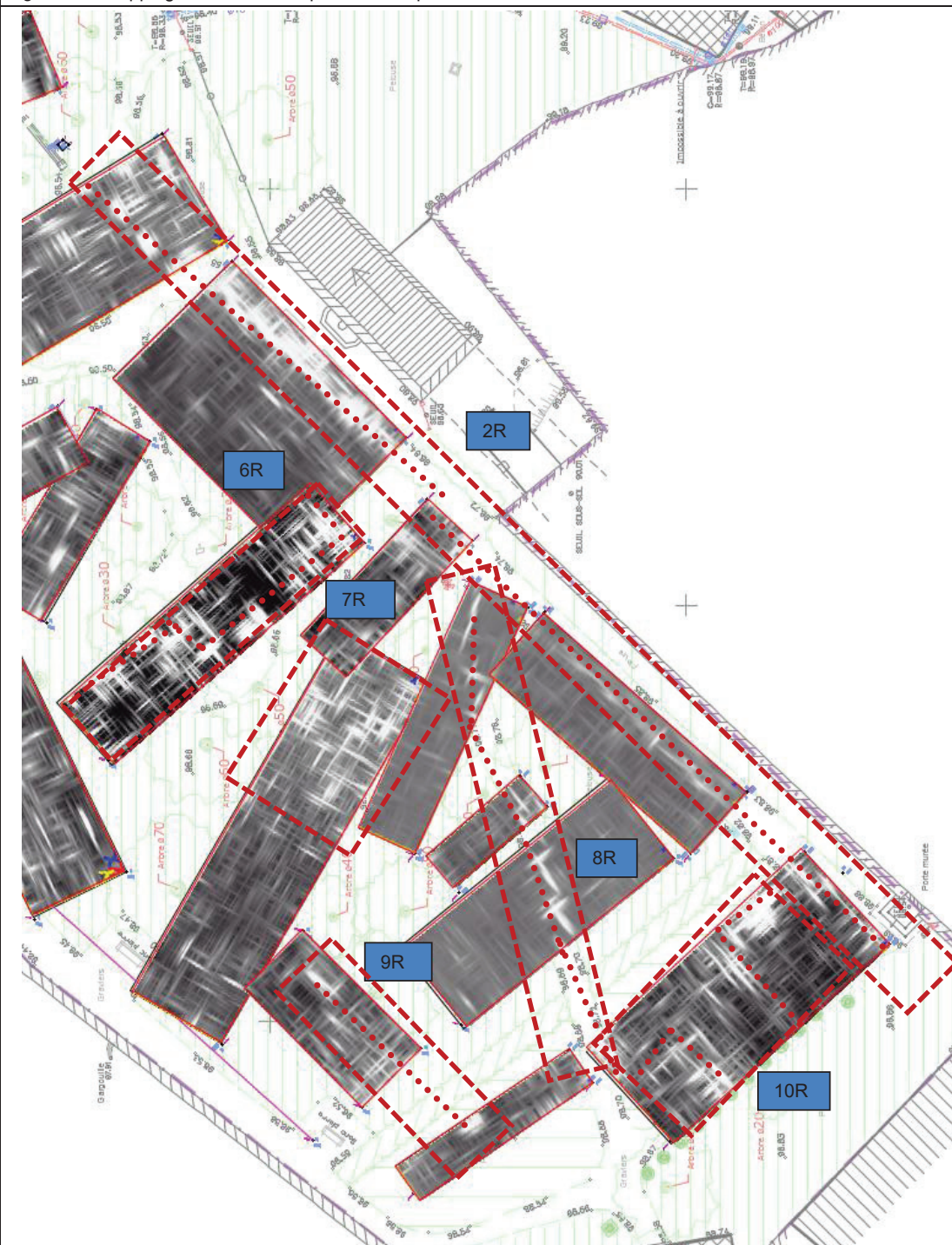
Figure 13 : mapping radar haute fréquence de la partie sud du site en z = 0.40 et 0.60 m
