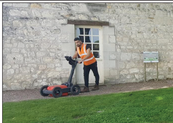
Figure 9 : Acquisition au Radar Géophysique
