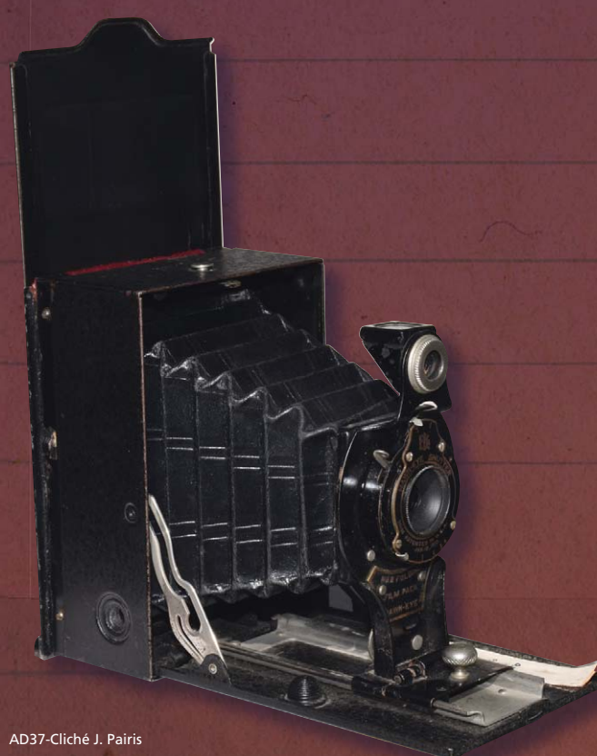
Appareil photographique à pellicule Hawk-Eye Schutter transformé pour des plaques de verre.
