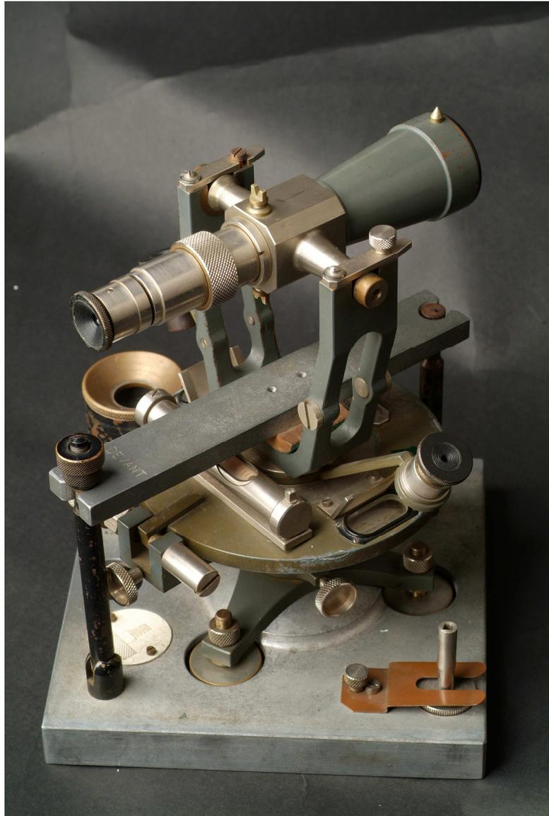
Le théodolite est un appareil de mesure des angles dans l'opération de triangulation. Il est essentiellement constitué de trois axes concourants et de deux cercles.
