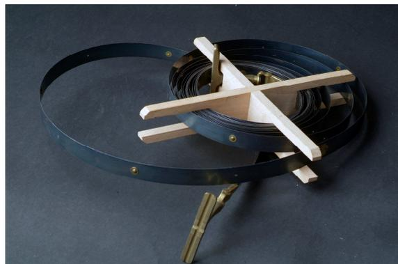
D'une longueur totale de 10 ou 20 m, elle est portée par 2 opérateurs : l'un dit *chaîneur* reste toujours à une l'arrière, l'autre appelé *porte-chaîne*, à l'avant.
